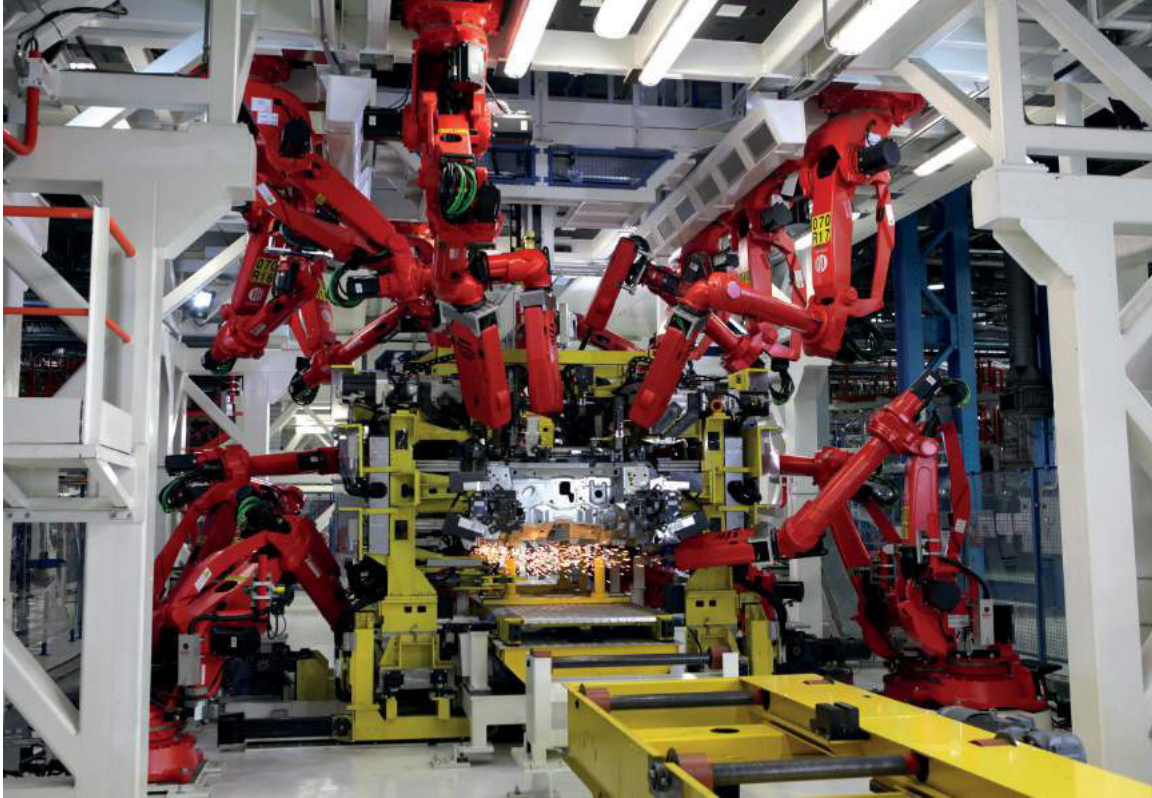
01 In der derzeit modernsten Fertigungsanlage von Comau „OpenRoboGate“ arbeiten bis zu 18 Roboter gleichzeitig auf engem Raum. Die allgemeinen Anforderungen und speziell die mechanischen Belastungen an die Kabel sind hier extrem hoch
